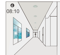
Wenn der natürliche Lichtpegel den Lux-Sollwert im PIR überschreitet, schaltet sich das Licht aus, auch wenn der Raum besetzt ist.
