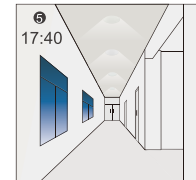
Das Licht schaltet sich automatisch mit 10% ein, wenn das natürliche Licht unzureichend ist (keine Bewegung)
